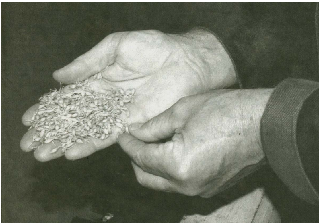
Sechs Tage dauert die Keimung im Keimkasten der Rhön-Malz. Weichen, Keimen und Darren beschreiben den Produktionsablauf in einer Mälzerei
